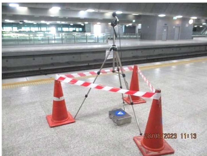
รูปที่ 4 การติดตั้งเครื่อง Sound Level Meter บริเวณชานชาลา 7, 8 (GPS 47P 0666738,1526746)
