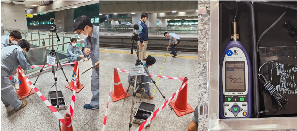
รูปที่ 2 การติดตั้งเครื่อง Sound Level Meter บริเวณชานชาลาที่ 1-2, 7-8 และ 11-12 ณ สถานีกลางกรุงเทพอภิวัฒน์
