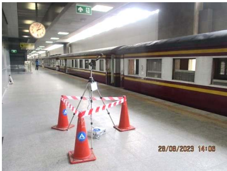
รูปที่ 2 การติดตั้งเครื่อง Sound Level Meter บริเวณชานชาลาที่ 1-2, 7-8 และ 11-12 ณ สถานีกลางกรุงเทพอภิวัฒน์
