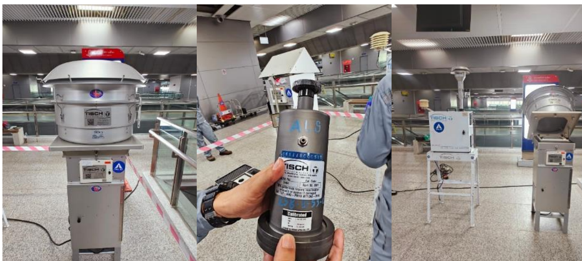
รูปที่ 4 การติดตั้งเครื่องเก็บตัวอย่างฝุ่นละอองในบรรยากาศ ใช้ในการตรวจวัดคุณภาพอากาศแบบ 24 ชั่วโมง บริเวณชานชาลาที่ 7-8 ณ สถานีกลางกรุงเทพอภิวัฒน์
