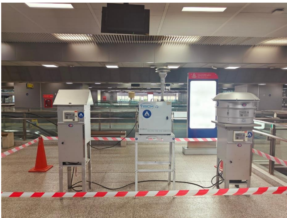
รูปที่ 3 การติดตั้งเครื่องเก็บตัวอย่างฝุ่นละอองในบรรยากาศ ใช้ในการตรวจวัดคุณภาพอากาศแบบ 24 ชั่วโมง บริเวณชานชาลาที่ 7-8 ณ สถานีกลางกรุงเทพอภิวัฒน์
