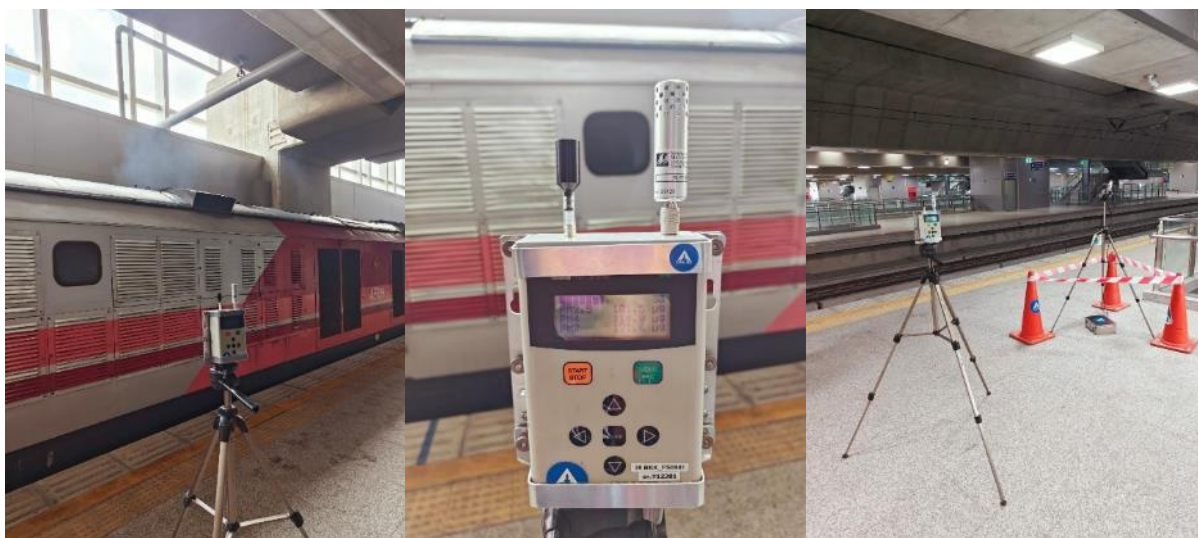
รูปที่ 2 การติดตั้งเครื่องตรวจวัดค่าฝุ่นละอองแบบพกพา ใช้ในการตรวจวัดคุณภาพอากาศแบบชั่วคราว บริเวณชานชาลาที่ 1-2, 7-8 และ 11-12 ณ สถานีกลางกรุงเทพอภิวัฒน์
