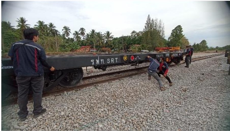
รูปที่ 15 การวัดความโก่งตัวทั้งฝั่งซ้ายและขวาของตัวแม่แคร่ (Underframe)
