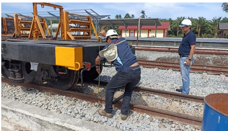
รูปที่ 12 การใช้ตลับเมตรวัดระยะสูงสุดของ Flat wagon
