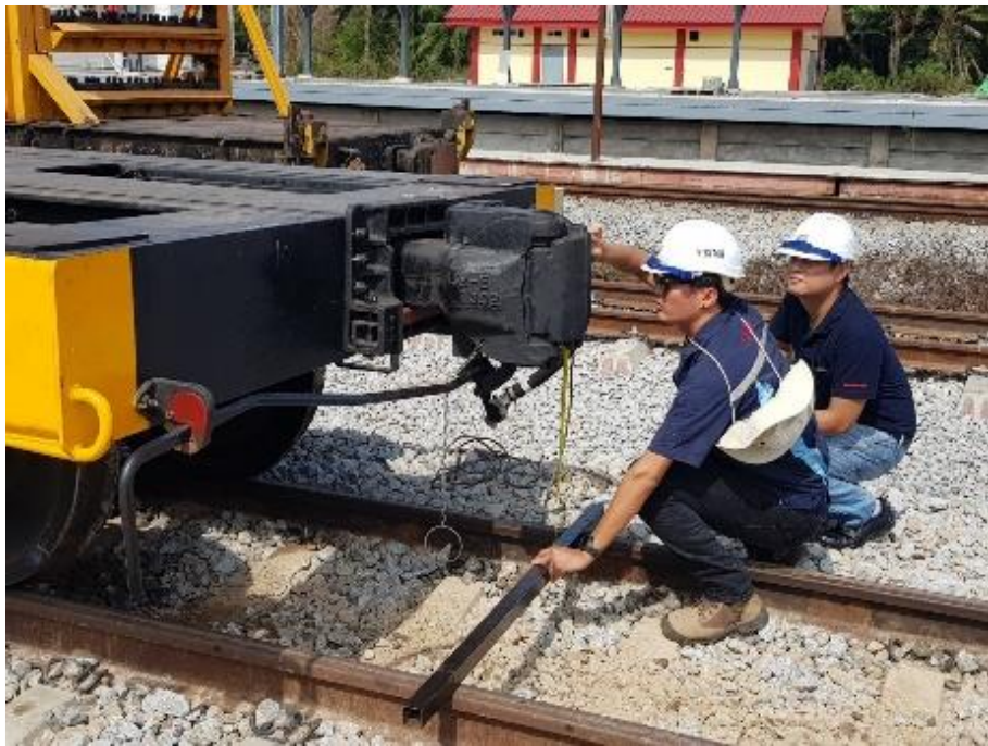
รูปที่ 14 การวัดความสูงของตำแหน่งขอพ่วง
