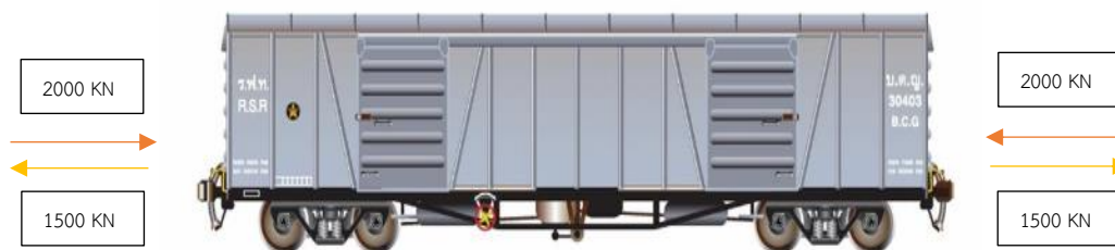
รูปที่ 5 การทดสอบแรงกดและแรงดึงแนวนอน
