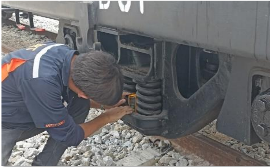
รูปที่ 13 การวัดระยะความสูง Coil Spring ในรูปแบบ No-Load
