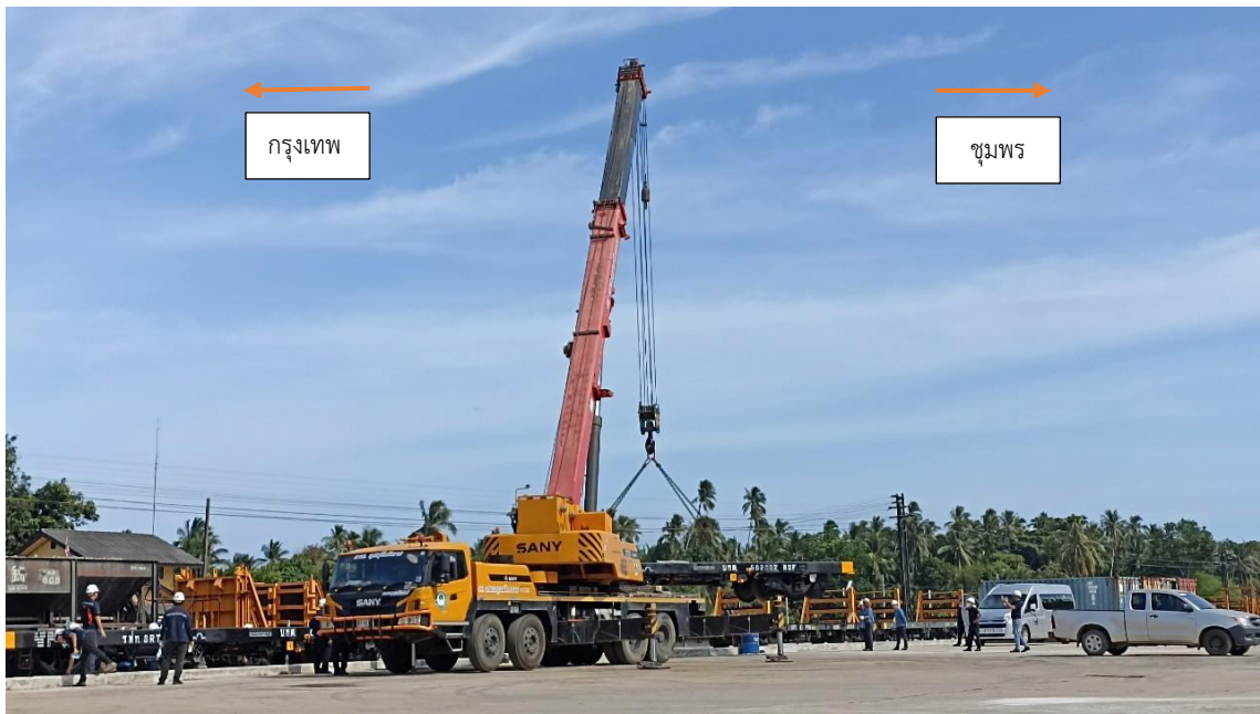
รูปที่ 11 นำแคร่วางบนรางรถไฟ ณ สถานีรถไฟบางฝักขวง
