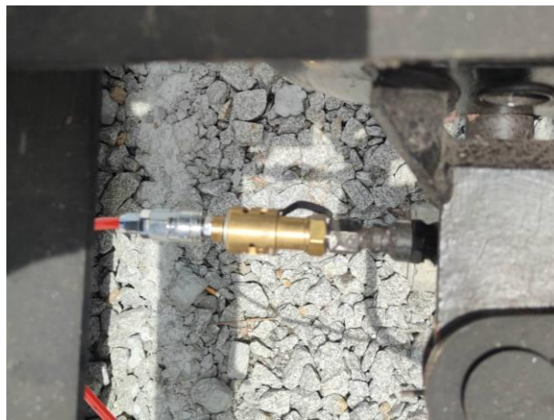
รูปที่ 16 การต่อท่อจากเครื่องวัดไปยังตำแหน่งที่ระบบเบรกปล่อยลมออก
