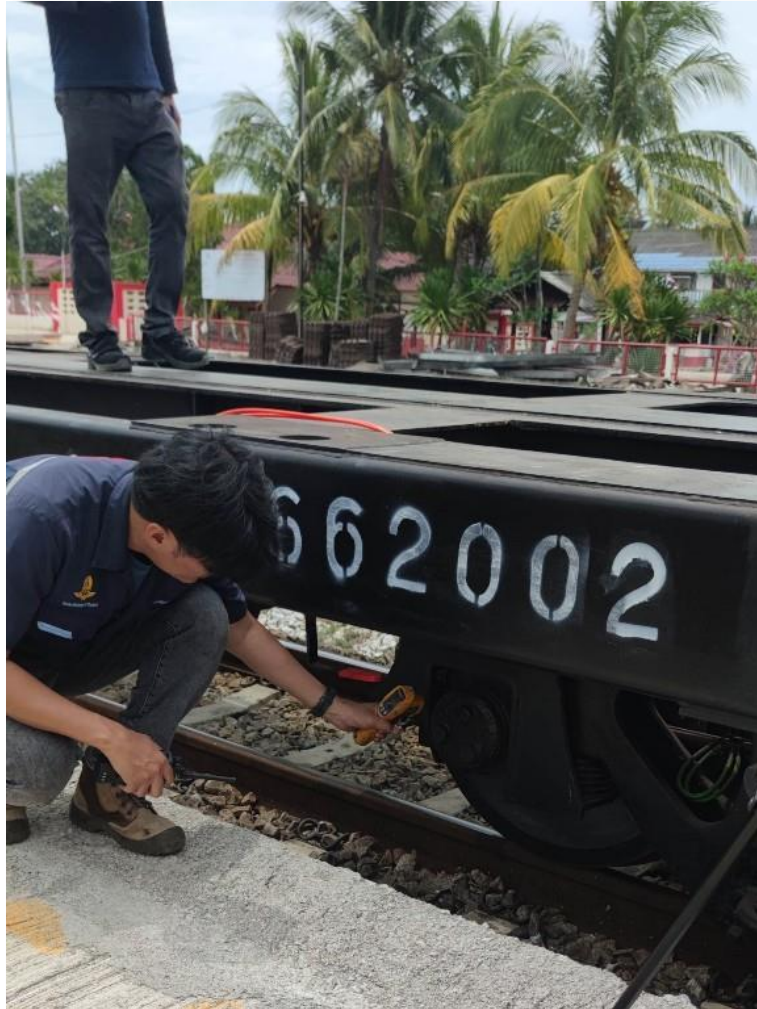
รูปที่ 19 วัดอุณหภูมิเพลาล้อเมื่อทำการเบรกที่ความเร็ว 100 กิโลเมตรต่อชั่วโมง
