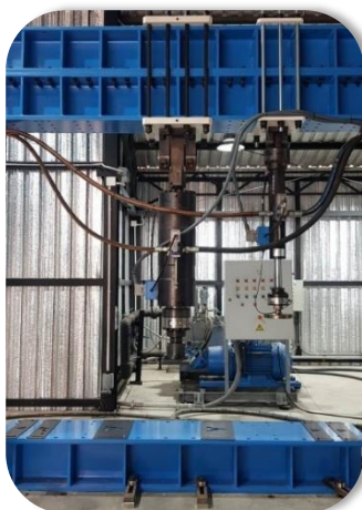
รูปที่ 11 ห้องทดสอบปฏิบัติการทดสอบหมอนคอนกรีตสำหรับรถไฟ
