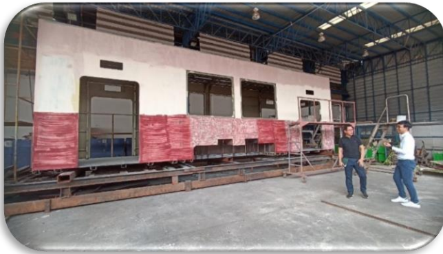
รูปที่ 19 การประกอบรถไฟฟ้ารางเบา ณ บริษัท ช.ทวี จำกัด (มหาชน)
