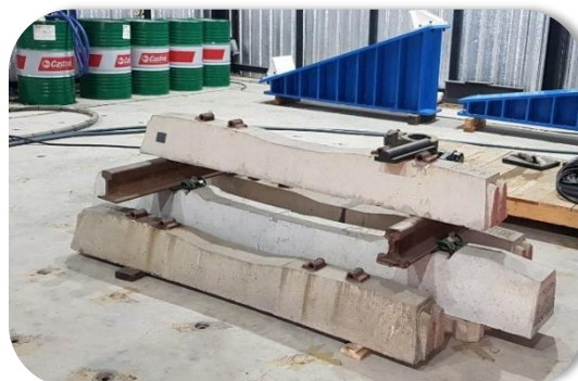
รูปที่ 11 ห้องทดสอบปฏิบัติการทดสอบหมอนคอนกรีตสำหรับรถไฟ
