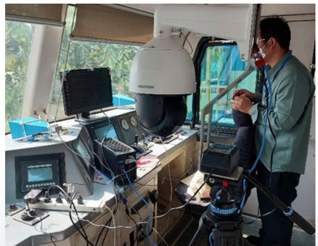
ภาพการทดสอบระบบค้นหาและแจ้งเตือนสิ่งกีดขวางด้านหน้าขบวนรถไฟโดย NECTEC
